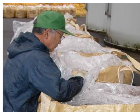
写真4 内袋の袋口を絞って固結び し、密閉
