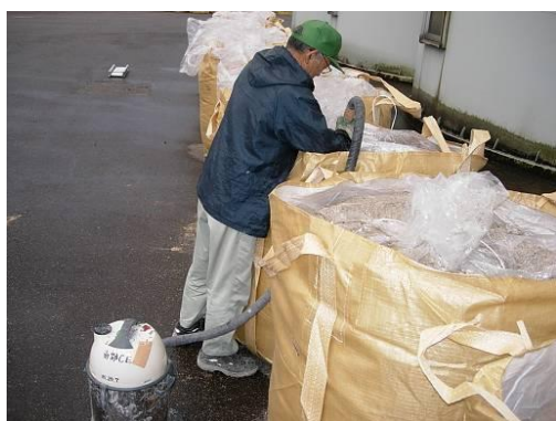
写真3 大型掃除機で内袋から 空気を吸引
