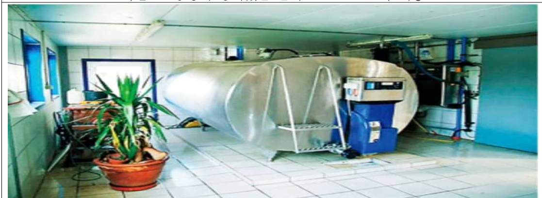
사진 3 농장에 놓여있는 쿨러. @SOLAREC사 제공
