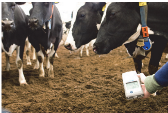
〈그림 4〉 축사 내부에서 이산화탄소 농도 측정을 통한 환기상태 평가
