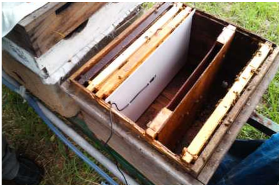
그림 92 CHIPCAP-L/Module 온습도 센서 실환경 설치 테스트
