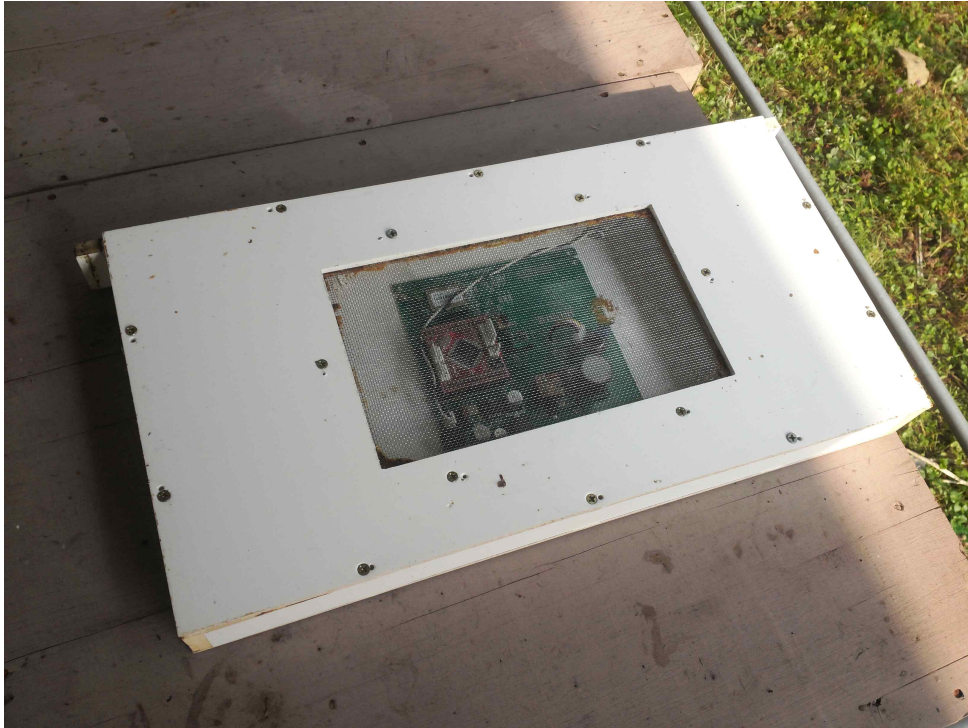
그림 312 최종 센서노드(센서소비) 모습
