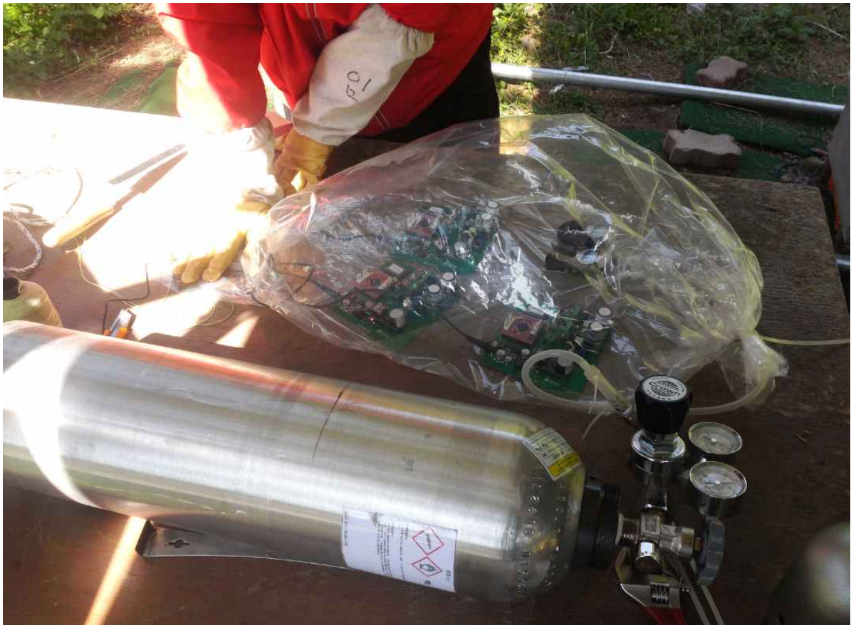
그림 111 표준가스 측정 실험
