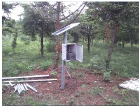
그림 60 데이터수집전송시스템 설치
