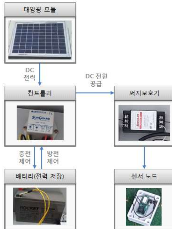
그림 30 센서노드 전원 공급 시스템 구성도
