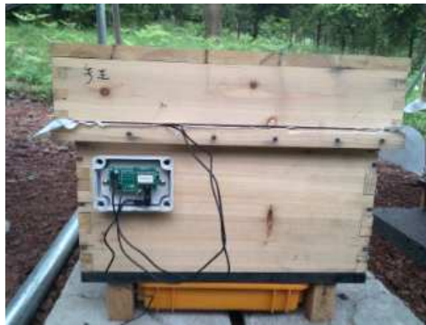
그림 52 센서 노드 외벽 설치
