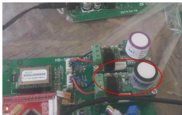
그림 106 적용한 황화수소 센서
