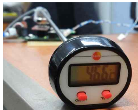
그림 100 MG811 CO2센서의 발열측정
