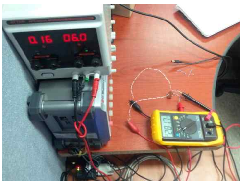
그림 99 MG811 CO2센서 소비전력 측정
