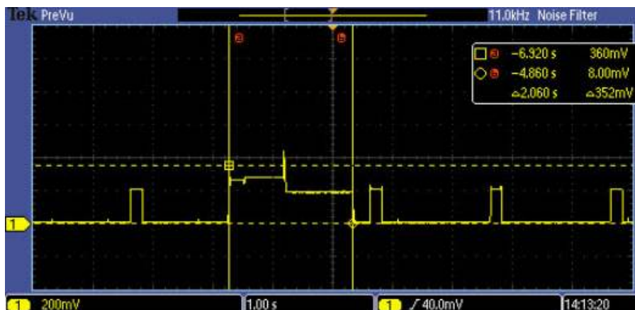
그림 187 센서 동작 시 센서로의 전력 공급 상태
