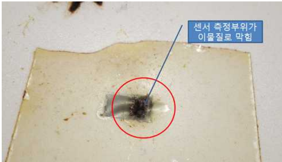
그림 93 센서 측정부위 막힘
