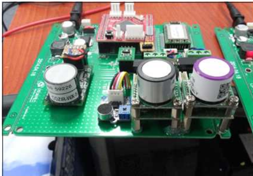
그림 299 PCB 센서 조립
