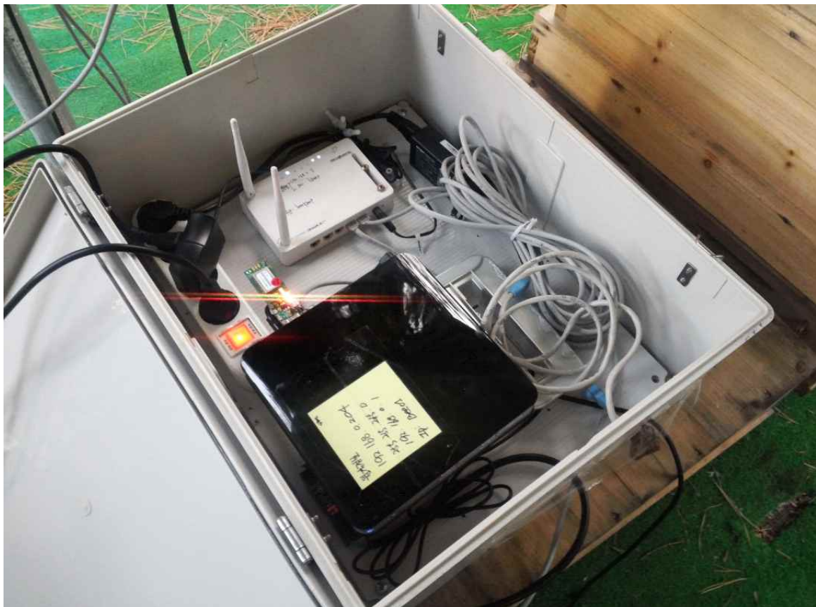
그림 115 소형 PC를 이용한 게이트웨이 설치
