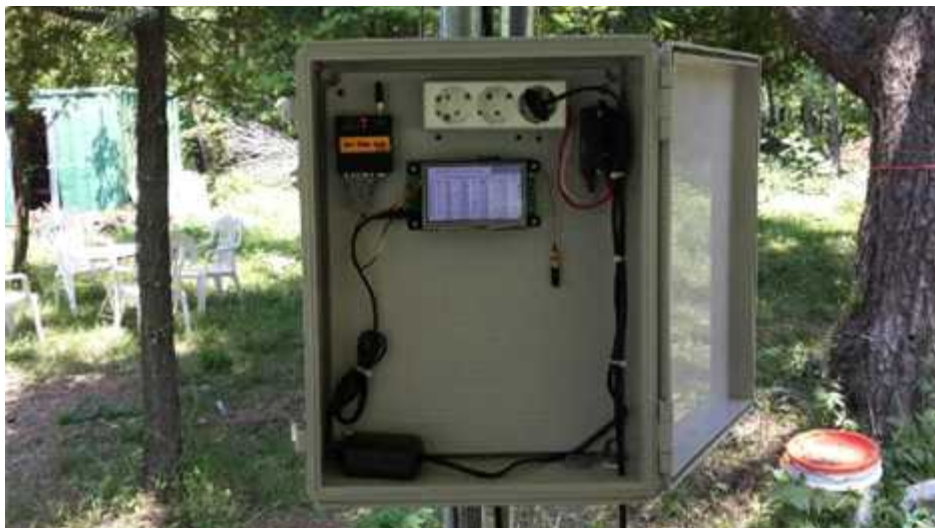
그림 323 외부보호함 내 데이터 수집 전송장치 설치_제주대 양봉장
