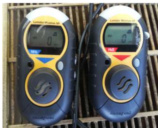
그림 108 좌측이 암모니아, 우측이 황화수소 측정 계측기
