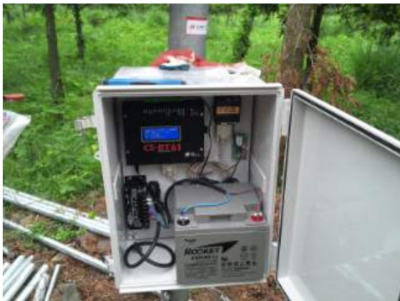
그림 37 외부 보호함 및 태양광 모듈 설치 모습
