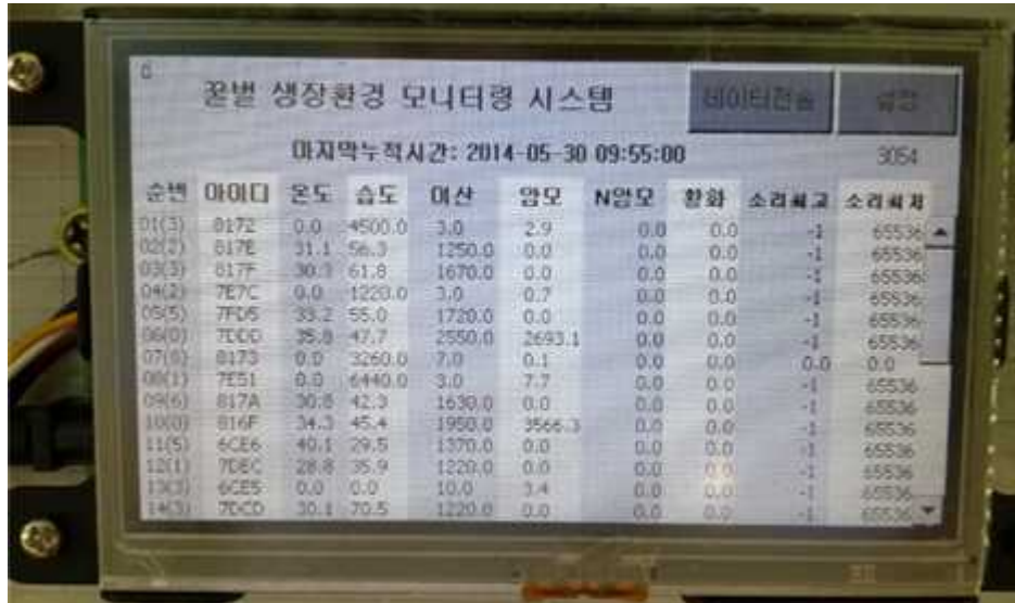
그림 324 설치된 데이터 수집 전송장치 확대 모습
