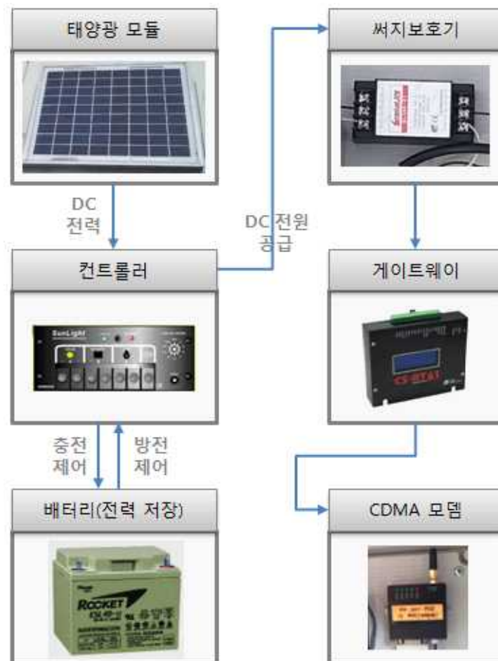
그림 36 게이트웨이 전원 공급 시스템 구성도
