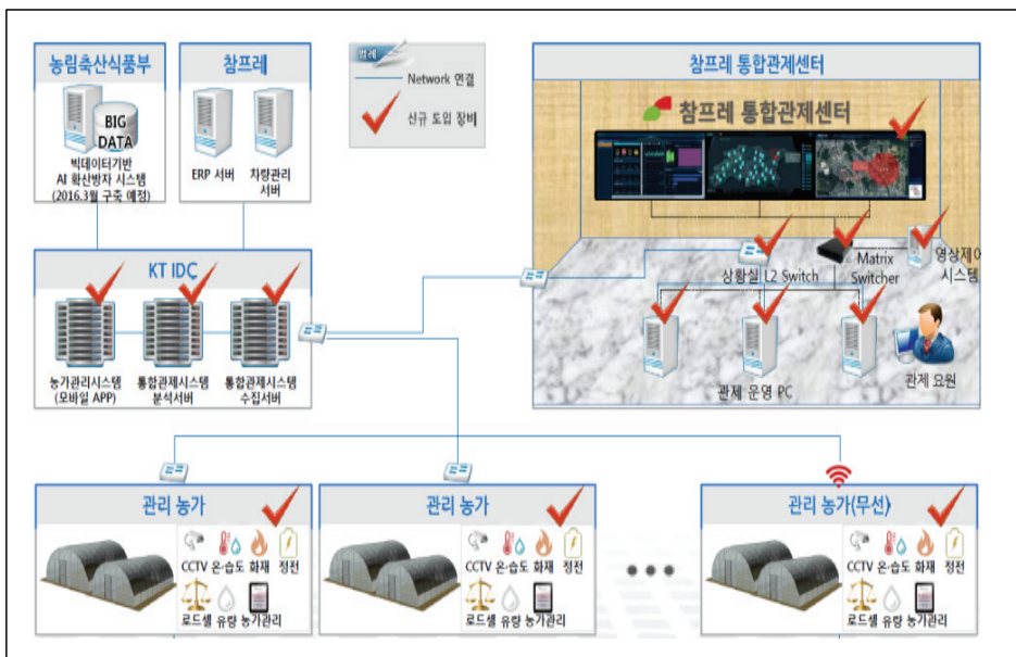
그림 2-7 계열화사업자의 가금농가 통합관제시스템
