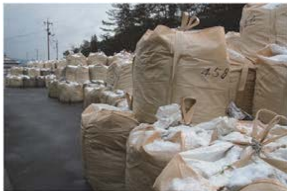
図 3-14 フレコンバッグの結び方
