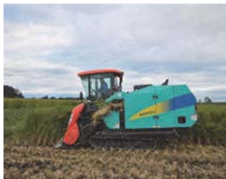
図 2-55 長稈対応のコンバイン型専用収穫機
