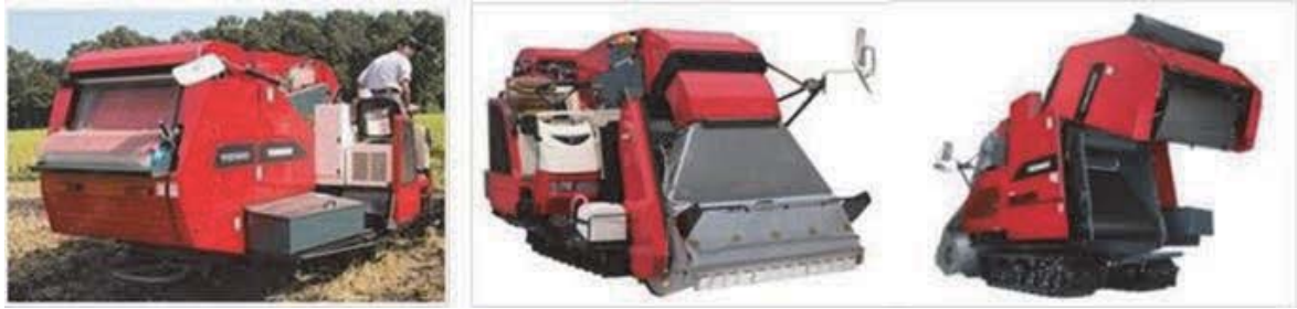
図 2-56 現在市販化されているフレール型専用収穫機
