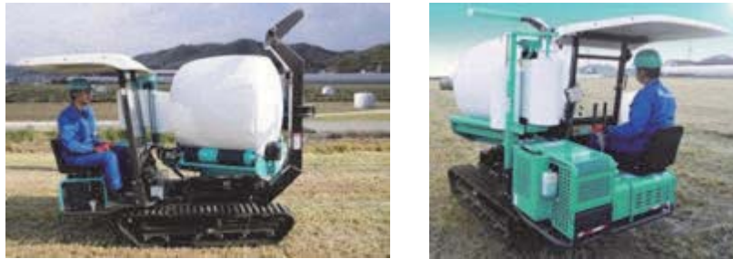
図 2－58 ディーゼルエンジン仕様の自走式ベールラップ
