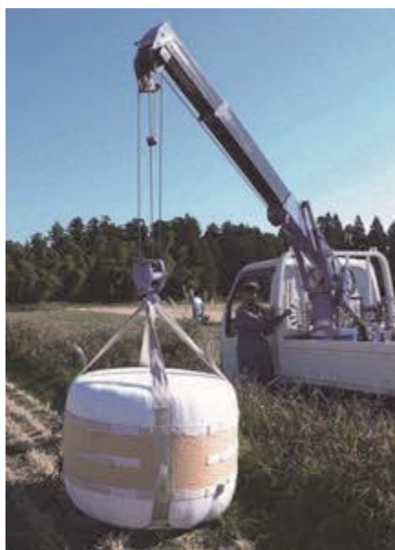
図 2-80 クレーン付トラックと簡易荷役具を用いた作業
