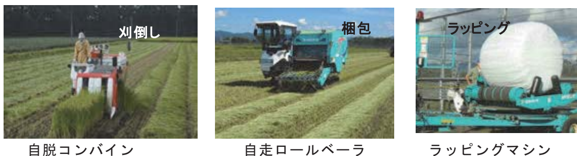
図 2-52 自脱コンバインと自走ロールベアラ用いた予乾収穫体系
