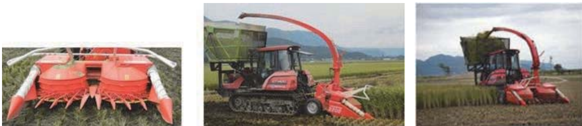
図 2－59 ロータリードラム式ハーベスタと WCS 用イネの収穫作業
