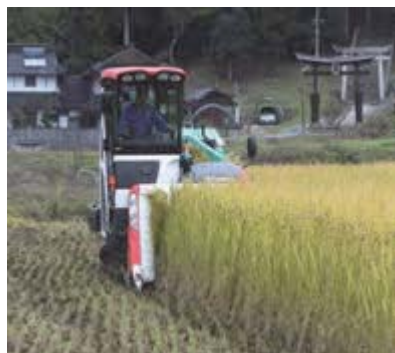
図 2-55 長稈対応のコンバイン型専用収穫機
